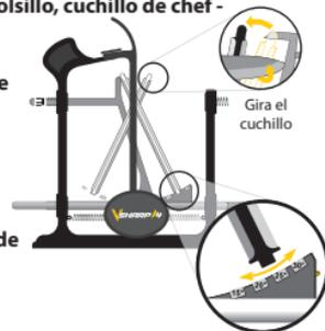
Afloje la parte superior de la muela y deslicela en la ranura del ángulo deseado en la parte inferior.
